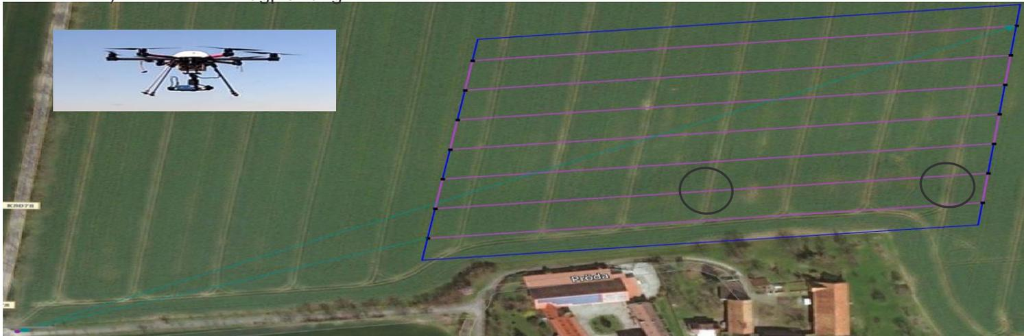
Flugplanung mit dem Programm „MiniGIS“ mit anschließender Übertragung der Wegpunkte auf das Unmanned Aerial Vehicle (UAV) (Hexakopter „XR6“ mit einer Multispektralkamera „TETRACAM“), Position der Verwallung ist schwarz eingekreist
